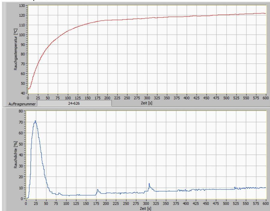
Bild 1: Zeitlicher Verlauf der Rauchgastemperatur und der Rauchdichte
