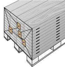
I-Profil als Schutzunterlage wenn geklammert oder getackert wird.
