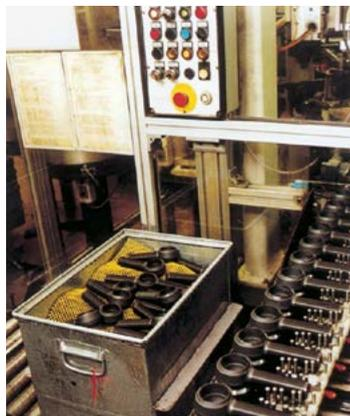
Zwischenlagegitter aus weichem PE und dienen als flächiger Kratzschutz auch für schwere Teile
